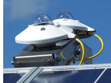
شکل ۱: پیرانومتر وسیله‌ای جهت سنجش تابش کل خورشید
