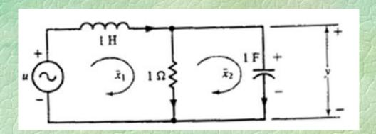
$$\begin{bmatrix} \dot{\overline{x}}_1 \\ \dot{\overline{x}}_2 \end{bmatrix} = \begin{bmatrix} -1 & 1 \\ -1 & 0 \end{bmatrix} \begin{bmatrix} \overline{x}_1 \\ \overline{x}_2 \end{bmatrix} + \begin{bmatrix} 1 \\ 1 \end{bmatrix} u$$
