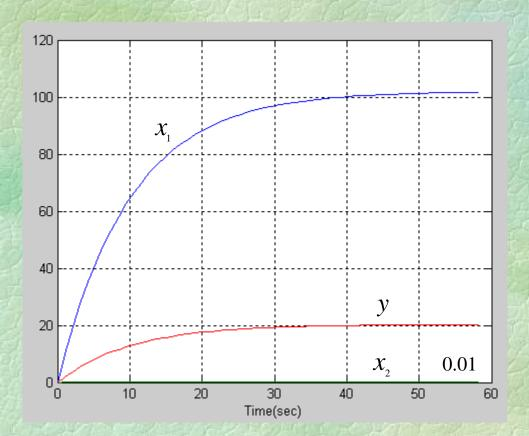
[y,x,t]=step(A,b,c,d); plot(t,x,t,y) grid on xlabel('Time(sec)')
