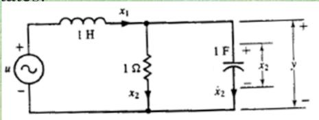
$$\begin{bmatrix} \dot{x}_1 \\ \dot{x}_2 \end{bmatrix} = \begin{bmatrix} 0 & -1 \\ 1 & -1 \end{bmatrix} \begin{bmatrix} x_1 \\ x_2 \end{bmatrix} + \begin{bmatrix} 1 \\ 0 \end{bmatrix} u$$
