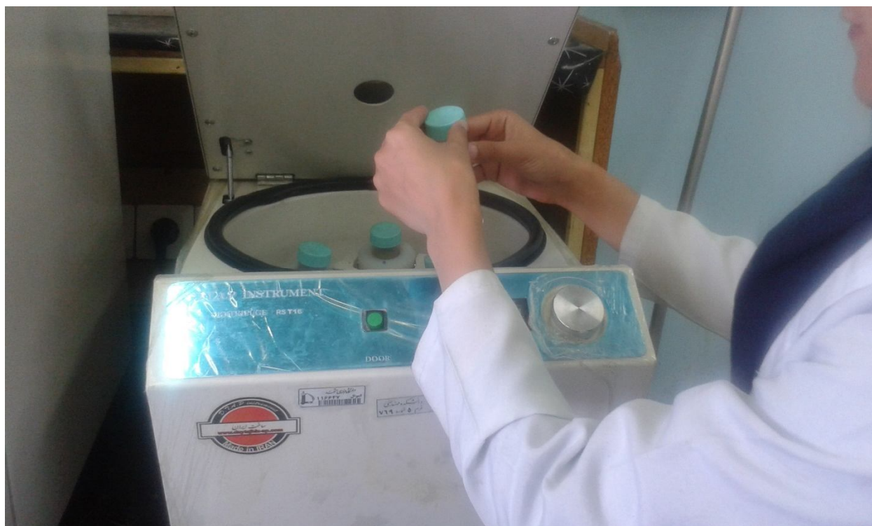
دستگاه سانتریفیوژ با سرعت چرخش بیشینه 4000 دور بر دقیقه برای جداسازی ذرات معلق
